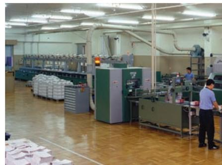
聴力障害者が働く職場には、3色で点滅し、機械のトラブルを知らせる警報ランプを設置。また、ゆるやかな段差の階段、切れ目のない階段手すりなど、肢体障害者に配慮した設計になっている
