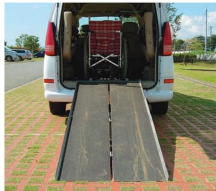
車椅子を載せるためのスロープは自社で製作
