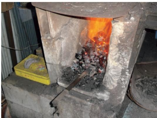
たたら製鉄の火床
