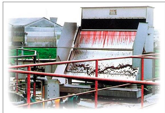
東洋スクリーン工業株式会社のウルトラTNスクリーン (wedge wire screenを使用した傾斜式の固液分離装置)
