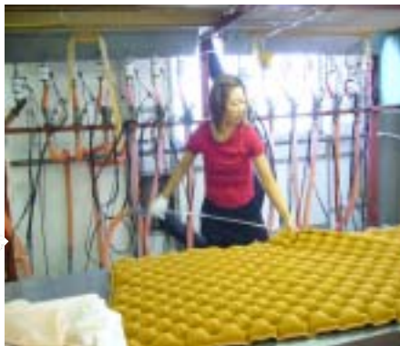
特殊な注入器によるビーズの注入作業
