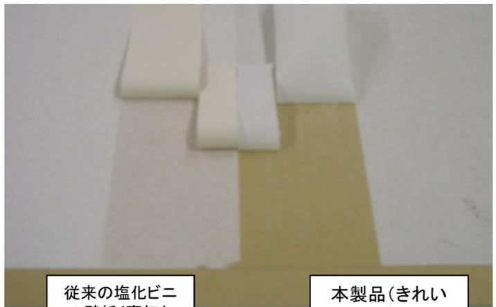
従来の塩化ビニル壁紙(裏打ち紙が残る)
