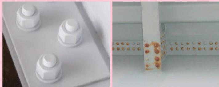
接合部における腐食促進試験結果（複合サイクル試験2000h）
