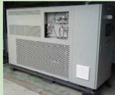
開発した実用化試験用水電解装置とスペック
