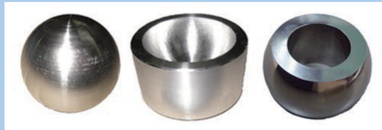
新加工法により得られた試作品 (左、中：人工股関節（骨頭、臼蓋）、右：スフェリカルベアリング)
