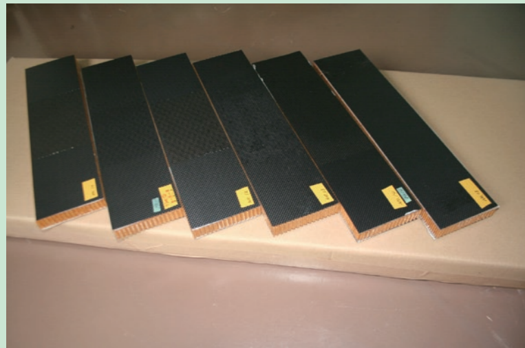
超軽量ジェットエンジン用消音パネル (CFRP製)
