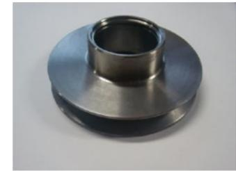
高強度・耐摩耗組織制御プレス金型台座
