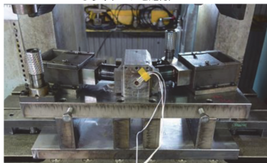
＜パイプ端面矯正プレス金型（中央の金型肉薄部にひずみゲージを貼付）＞
