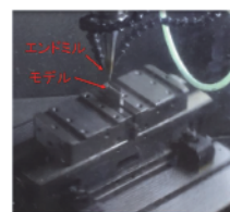
＜モデル翼部の切削加工の様子と切削イメージ＞
