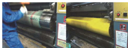
＜ウレタンアンビルカバー（左）現状の接合部形状、（右）ローテーションの様子＞
