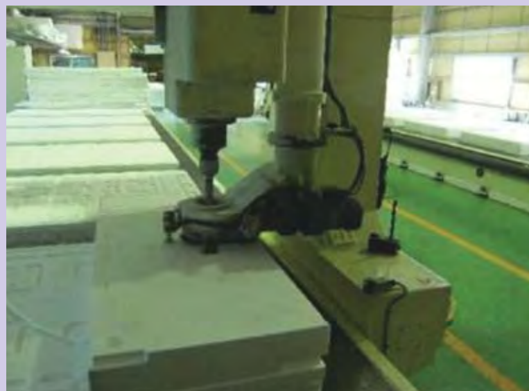
発泡模型機械加工テストの様子
