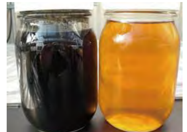
左が処理前の消化液、右が本装置で処理後の液肥
