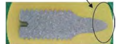
クリープ試験後の延性的な破断が良好
