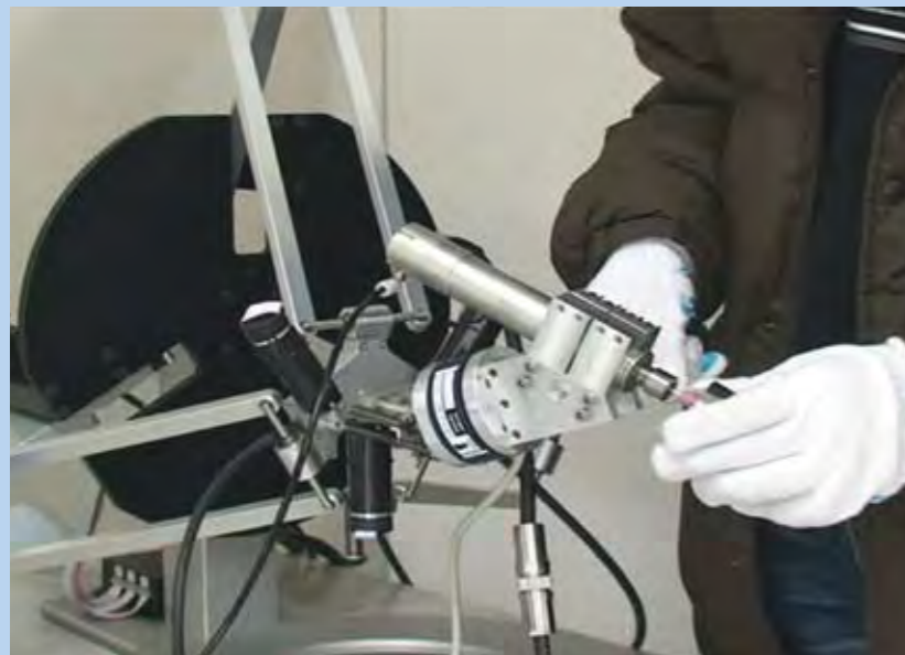
作業者との協調動作により精密加工を支援する加工支援ロボット
