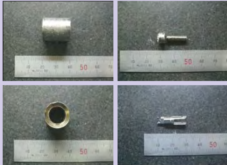
急冷遠心铸造法により製作した小型複雑形状部品
