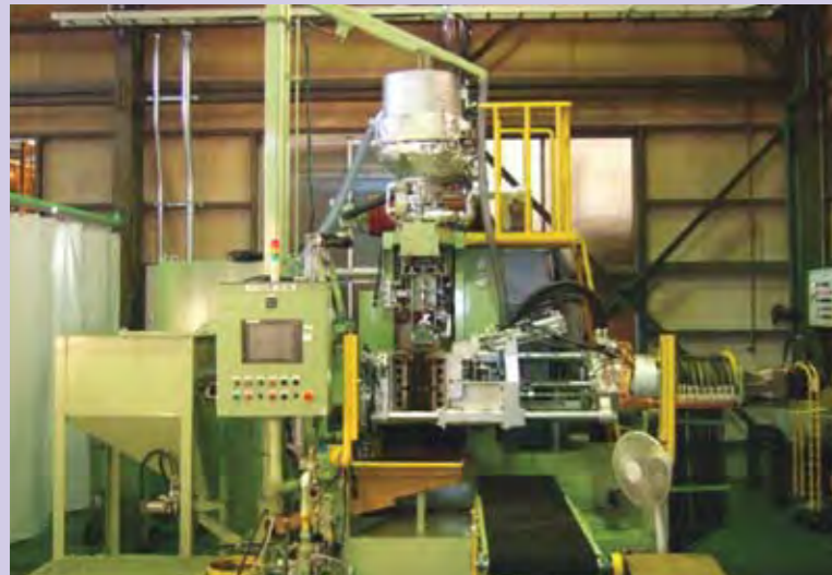
RCS材供給部分に蒸着化ユニットを設置した中子成型装置
