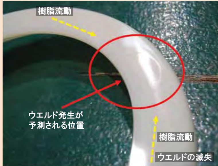
サーマルサイクル制御金型によるウエルドラインの減失
