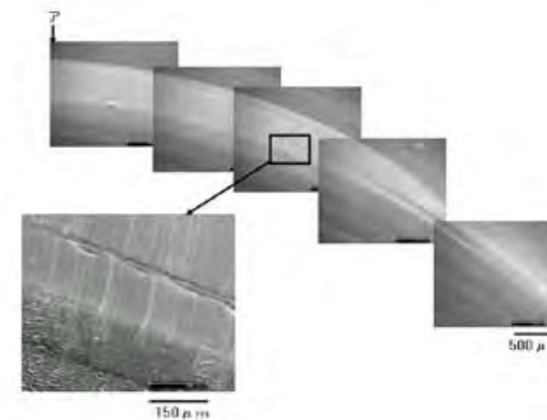
3分割型の安全弁部のSEM像(内面)
