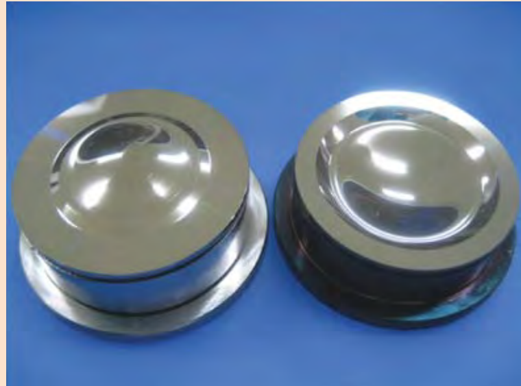
数μmの段差をもった光学素子用超精密金型
