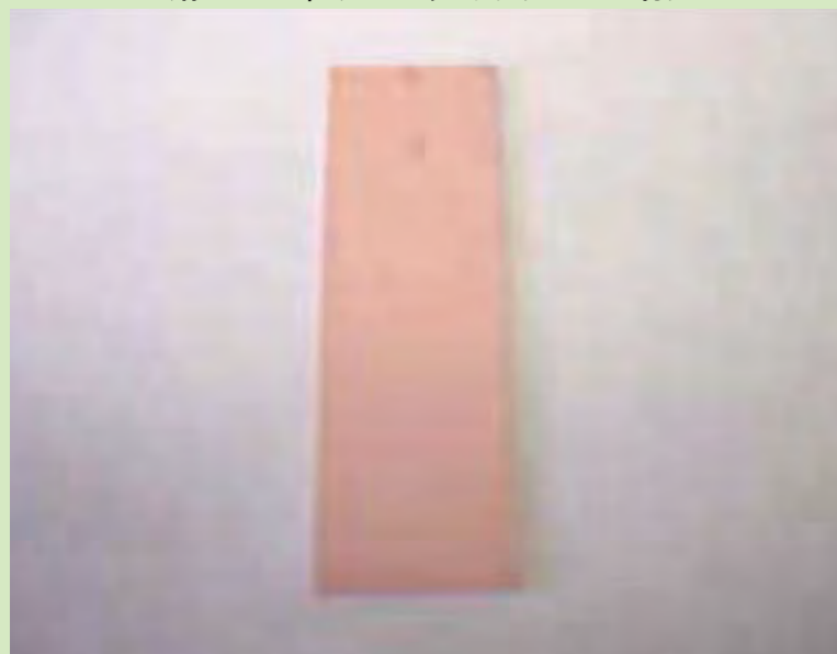
銅めっき20μm処理セラミック(マコール材)
