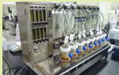
ジャーファーマンターによる培養条件検討
