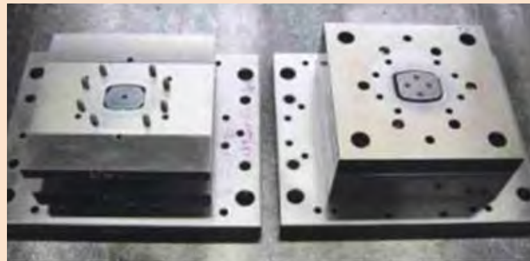
ボルトレス金型組立て状態
