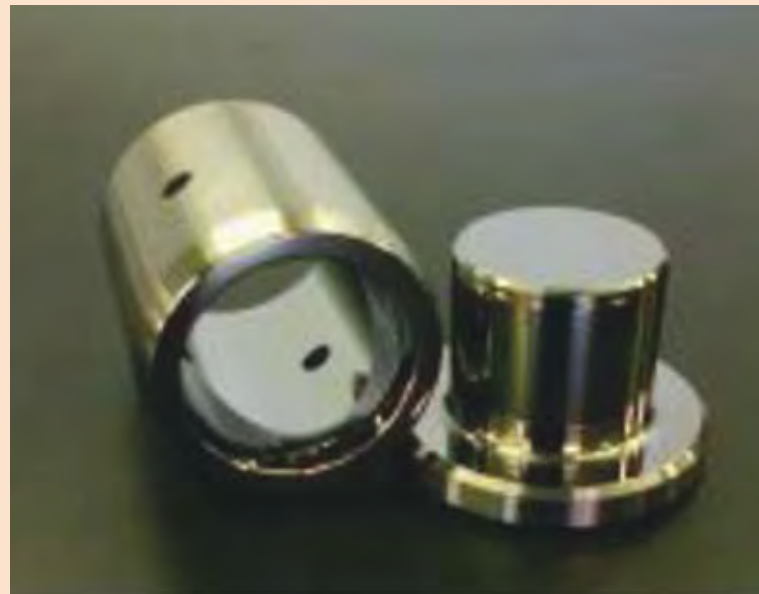
ナノ超硬合金製のガラスレンズ金型(φ20)
