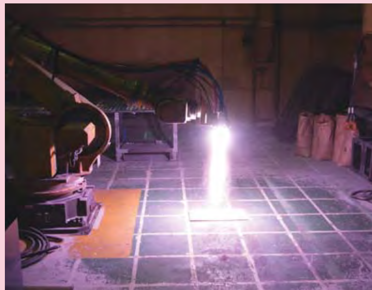
セラミック溶射材料による溶射状況
