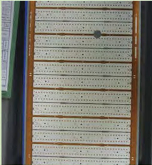
フィレット形成が良好な薄膜厚のAgめっき
