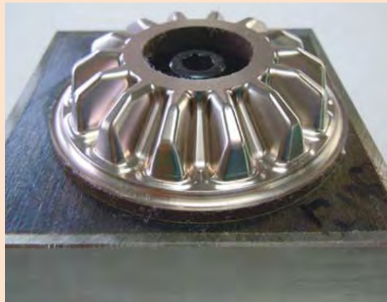
ベベルギア形状電極(試作品、マシニング加工後)
