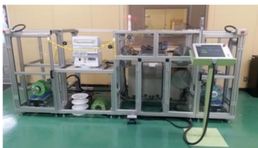
図表 5. 導入した異型伸線加工機
