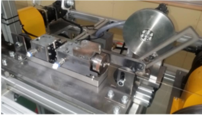
図表 8. 改良した前後動ダイスホルダ
