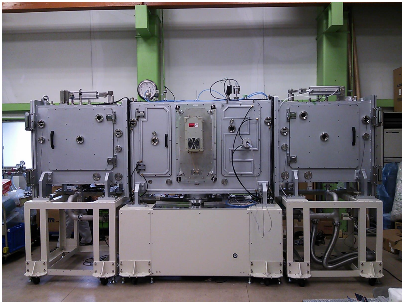
図 4. 開発した CtoC 方式 PIAD 装置の外観
