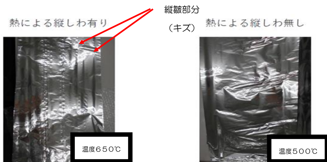
図 16, アルミ箔のヒータ加熱での熱しわの有無
