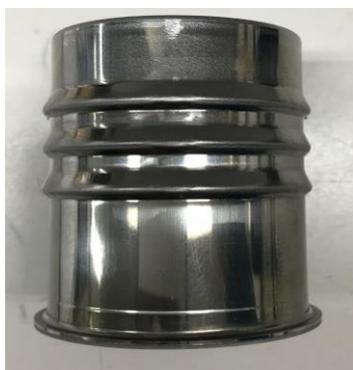
研究開発により確立した金型によるバルジ3個のプレス試作品
