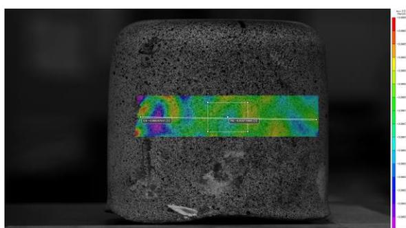
非接触ひずみ計によるひずみ計測の様子
