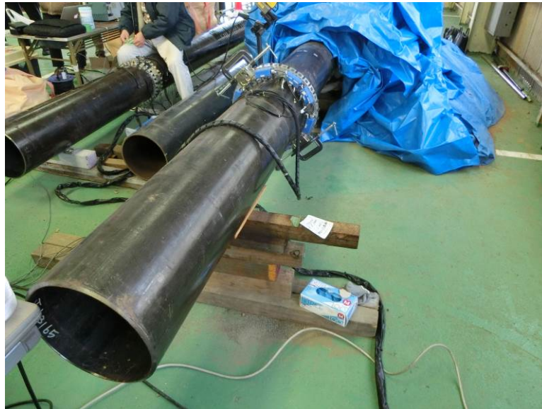
図 2.5.1 基本性能試験状況写真 (端部信号レベル比較)
