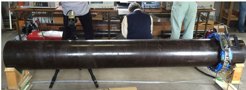
図 2.3.10 ガイド波表面変位計測実験写真
