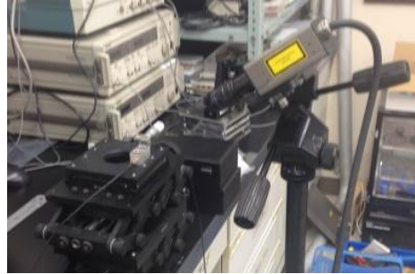
図 2.3.5 センサ面振幅計測写真
