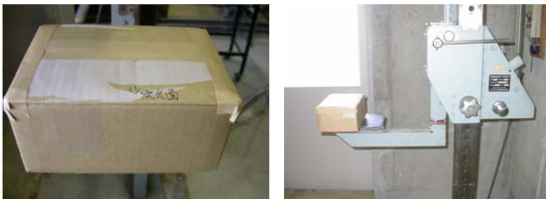
図 20 落下試験機への包装容器の設置の様子
