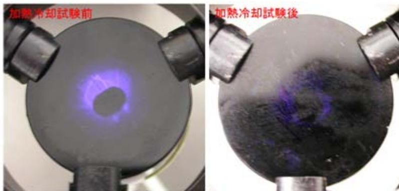
図 23 加熱冷却試験前後での発光の様子 (YAB29)
