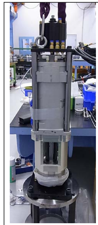
25kW モーター直結仕様 スピンドルユニット
