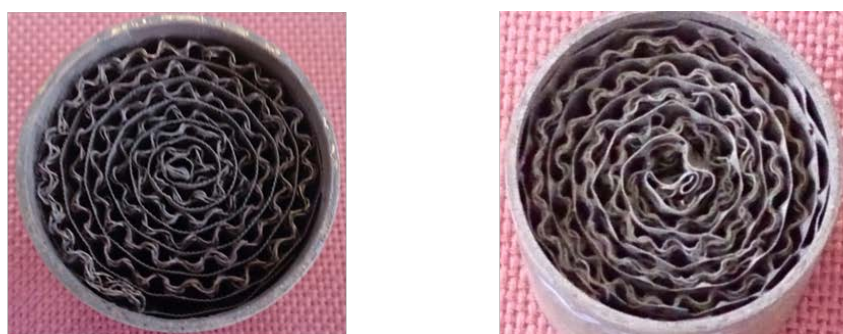
図10 巻き上げ装置による複合構造試作品(左)／手巻きによる複合構造試作品(右)
