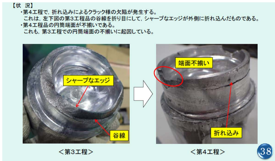
図【3】-(1)-⑥ ヨーク鍛造品の形状不具合
