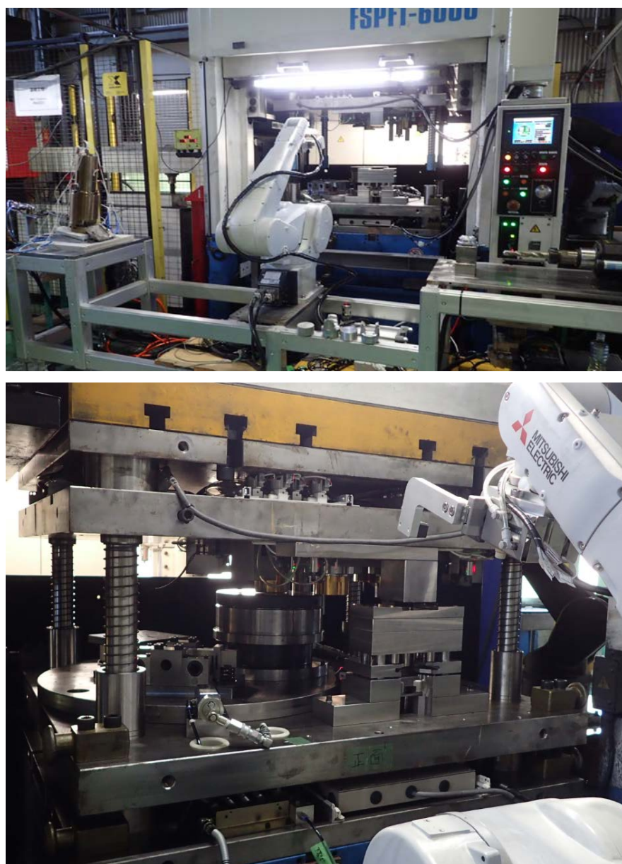
図【2】-(1)-① ターレット鍛造装置の動作している様子
