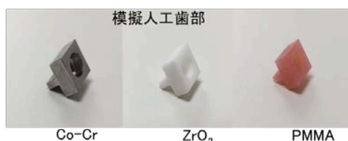
試料片の作製 上部 10x10x6 mm 下駄部 10x5x1.8 mm
