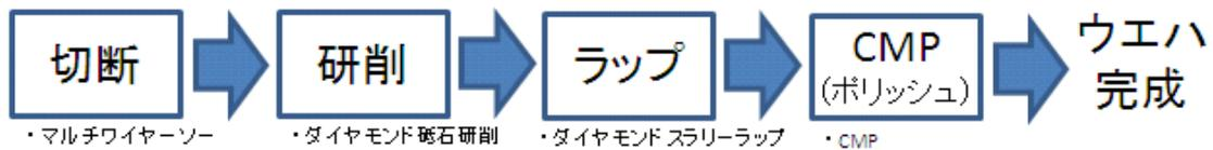
図 1 従来 SiC ウエハ加工プロセス
