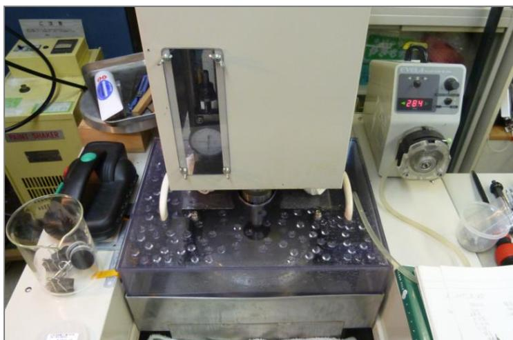
図6 砥石性能検査研磨装置の写真
