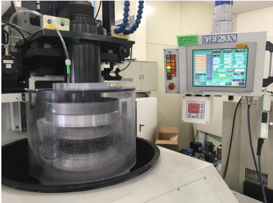
図4 グラインドラップ定圧研磨装置
