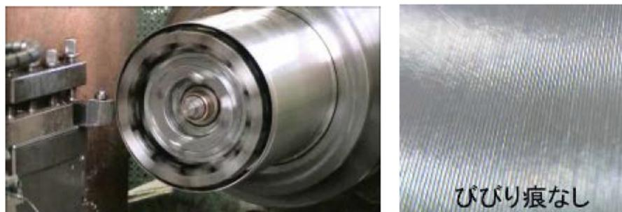
図 2-9 肉厚 1mm の薄肉円筒工作物に対する切削実験写真と加工後の工作物表面
