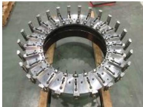
図 3-3 大口径制振装置
