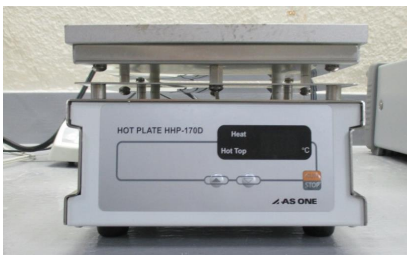
図 12 接着工程に使用したホットプレート
