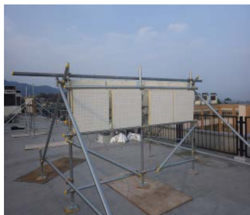
図 5-6 ALC および ECP 試験片設置状況
