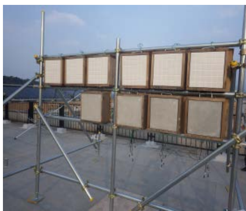
図 5-5 RC 試験片設置状況
