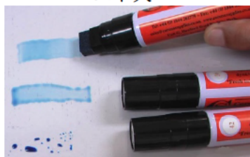
写真 1.1 ぬれ試薬ペンによる評価
