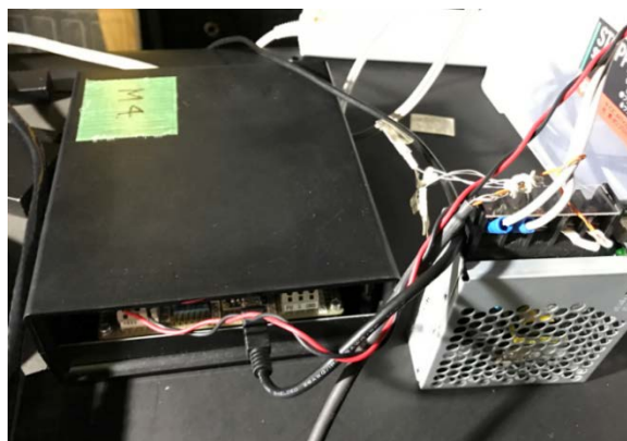
図 2-2-3 青色ライン LED コントローラーおよび設置状況図
