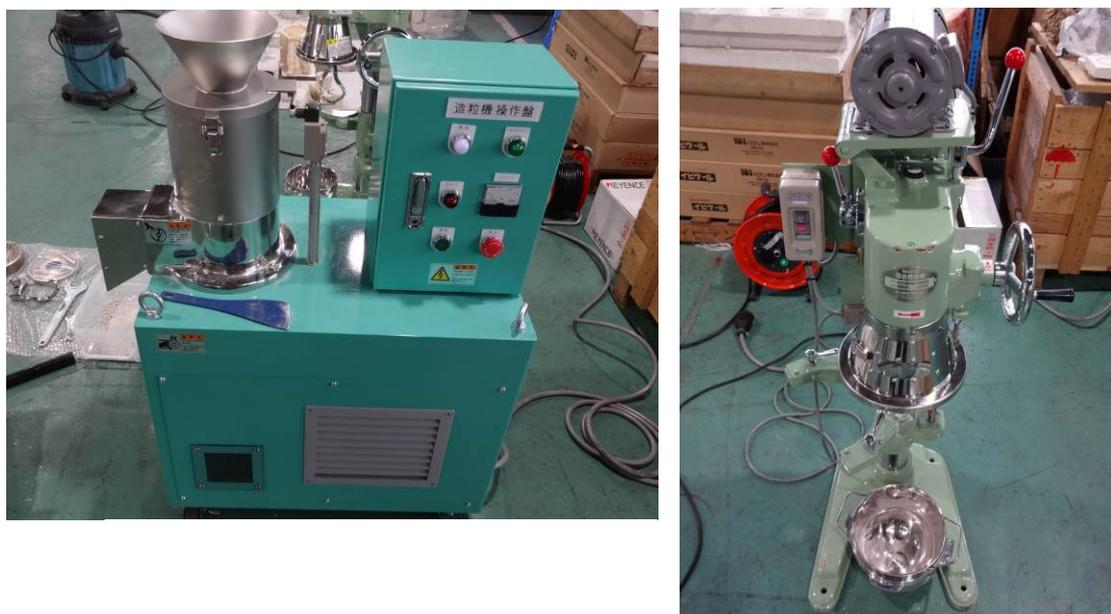
図 5 原料粒度調整器（左：半乾式造粒器、右：混合器）
