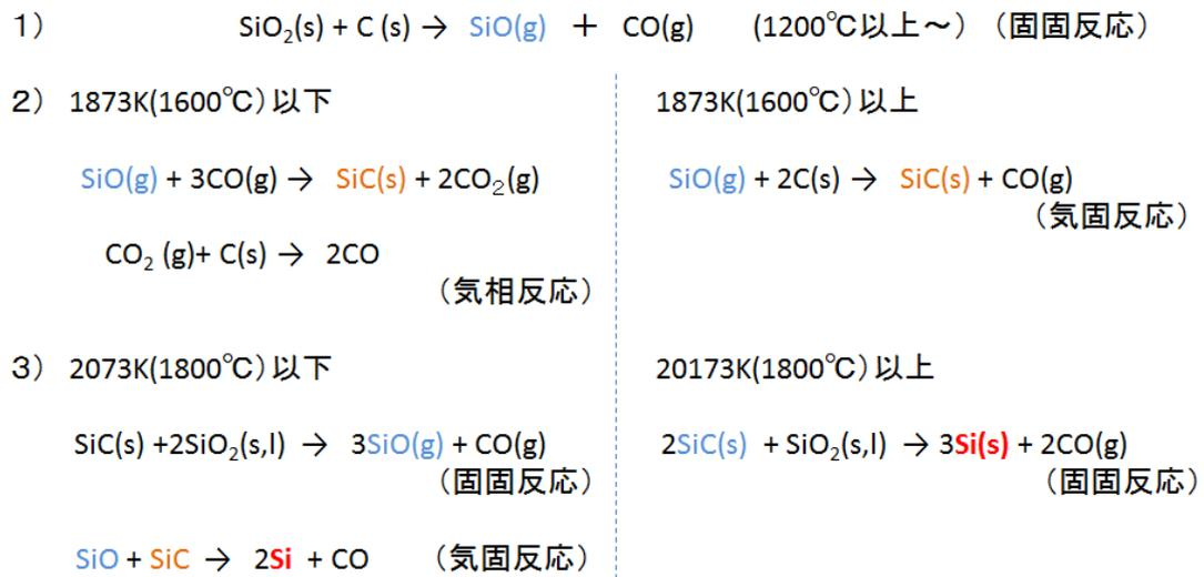
図 13 シリコン生成反応で想定される反応式
