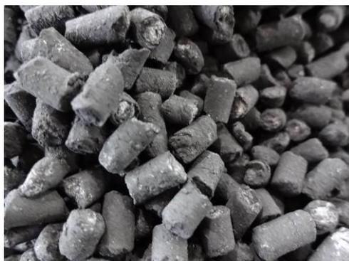
図6 造粒器によって作成された原料ペレット（ $\phi$ 5mm）
