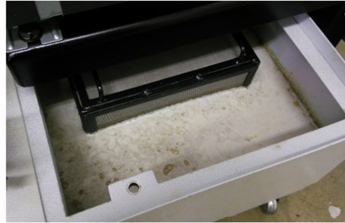
ファインバブルを用いて研削加工後の クーラントタンク写真
