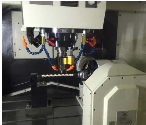
実ワークを研削加工している様子
