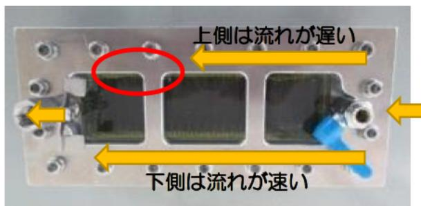
図2-25. 可視化実験用成形型セット
