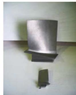
図 1-5. チタン合金製ブレード (IHI 技報 Vol.53 No.4 (2013))
