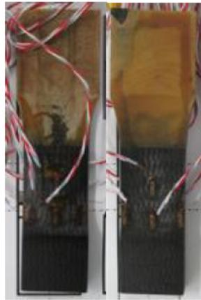
図2-11. ブレード引張破壊試験供試体
