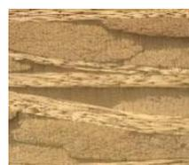
図1-10. 耐熱FRPの断面
