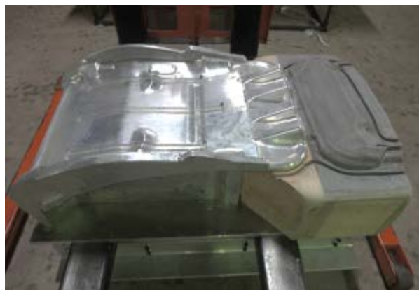
図43 下型（アルミ削り出し＋一部反転によるFRP樹脂）
