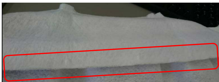
図40 温度が均一で綺麗な切断面
