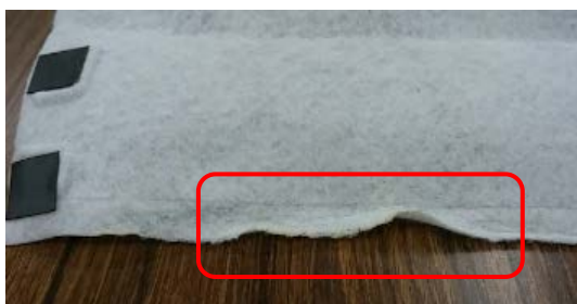
図39 温度ムラによる変形
