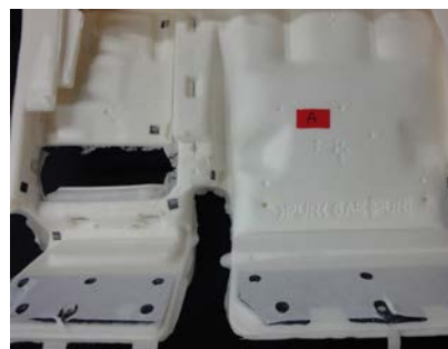
図58 シートパッド (インサート材+ウレタン)
