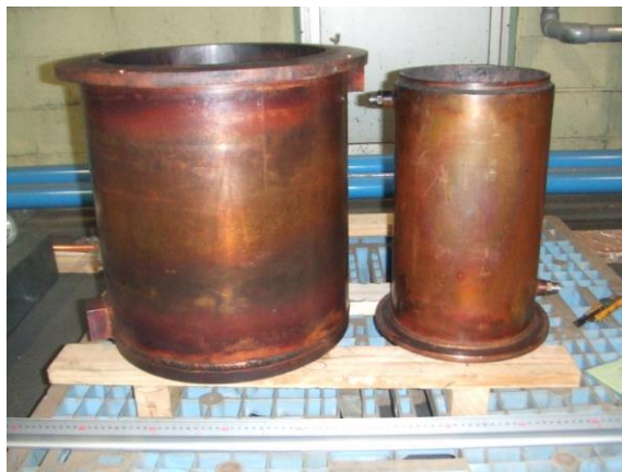
図 2-5-1 鋳型兼用水冷るつぼ（左 実規模、右 基礎特性評価用）
