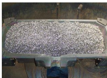
図 2-3-1 チップ状のチタン原料 (147kg セット)
