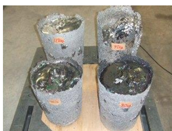
図 2-3-2 スカル (溶解容器中) 図 2-3-3 インゴット(溶解製品) 図 2-3-4 炉内蒸着物 (剥離して集め、計量)
