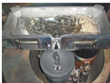
図 2-3-2 スカル (溶解容器中) 図 2-3-3 インゴット(溶解製品) 図 2-3-4 炉内蒸着物 (剥離して集め、計量)
