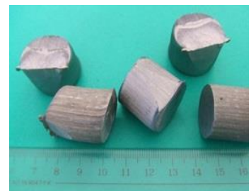
図 1-4-3 切断した NbTi 原料 (長さ約 2.5cm)
