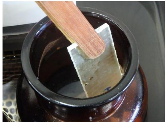
強度予測のため、管内面が劣化し、管外面の劣化のない平板サンプルを作製した。平板は異なるガラス繊維を用いたガラスクロスを積層し、成形品を硫酸と硝酸に浸漬して劣化した平板を製作した。促進試験（温水浸漬等）により劣化させた GFRP モデル材（平板）について、表面・断面観察、重量測定、曲げ試験を行うことにより劣化状況を把握した上で、超音波エコー測定を行い、劣化状況と超音波エコーの変化との関係性を明らかにした。得られた結果の一例を以下の図に示す。
