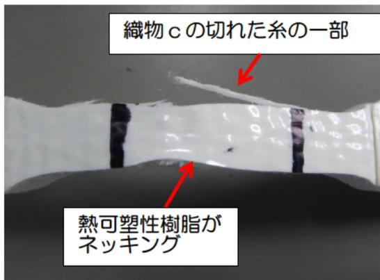
80℃試験後 破断部の状況
