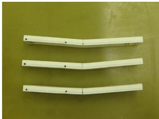
曲げ試験後の試験片
