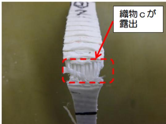
100°C試験後 熱可塑性樹脂の切断箇所
