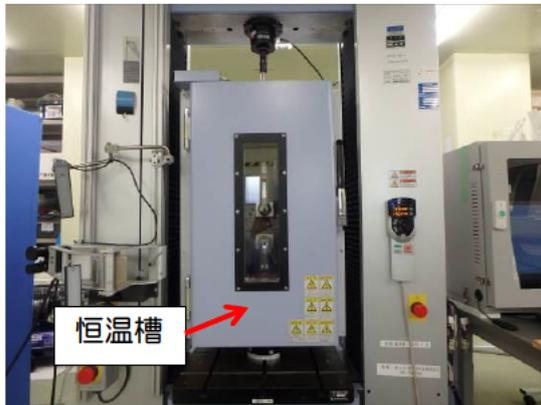
試験装置（オートグラフ、恒温槽）
