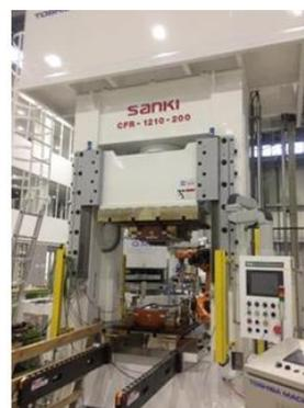
図2-1-1. シート加熱機及び材料搬送ロボット      図2-1-2. 200トン油圧プレス機
