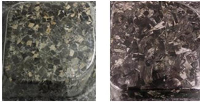
図2-1-6. BOX形状賦形金型成形品（左：H&C成形、右：スタンピング成形）
