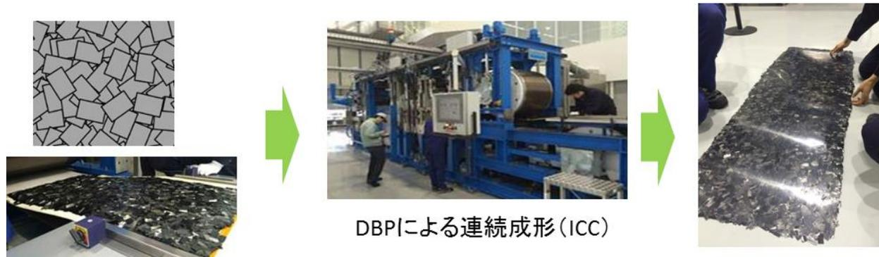
図3-2-1. ダブルベルトによるランダムシートの連続成形
