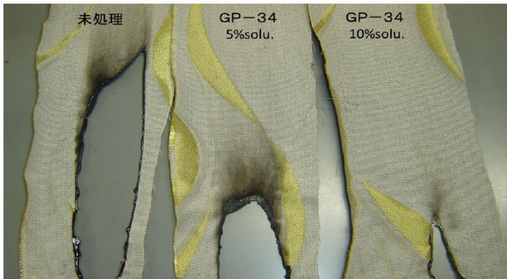
図9 GP-34 を加工したカーテン生地の垂直燃焼性試験
