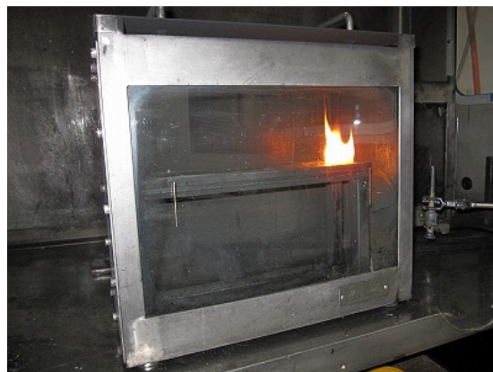
図 1 FMVSS による燃焼試験
