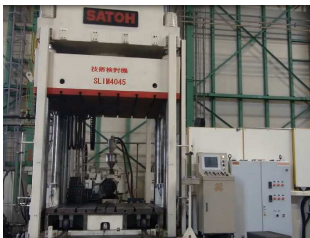
図 5.2.1 ハイブリッド成形技術開発検討機および仕様
