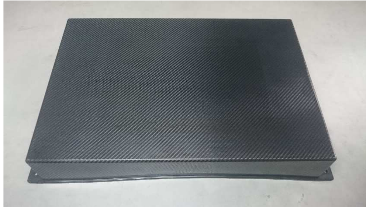
図 5.4.1 改造後の成形品（プリプレグ材側）
