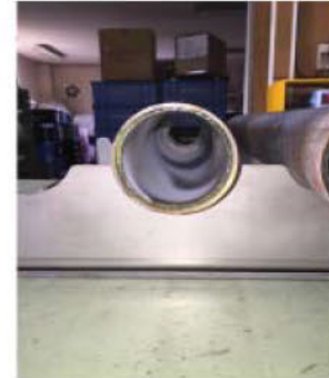
SUS管内にガラス管（新組成品）を入れ加熱実験
