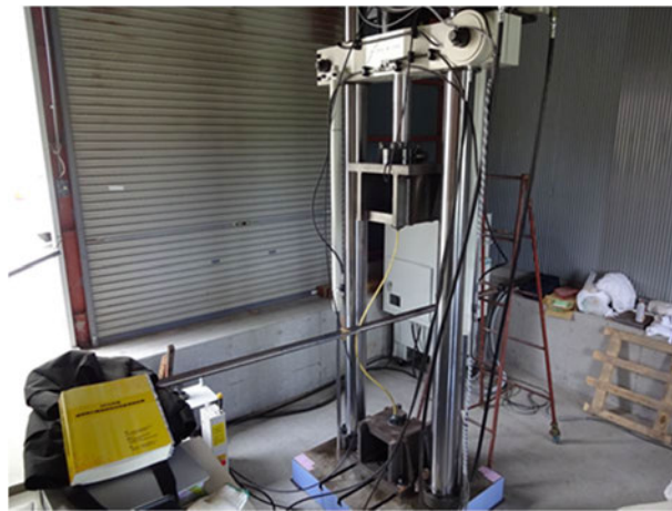
20 サイクル正負繰返試験 試験実施状況
