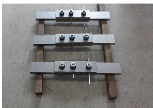
滑り耐力確認試験/データ
