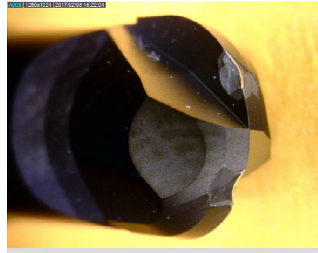
170317 既存工具 SR22C 30^{\circ} Z切り込み0.1
