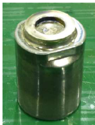
図2-3-8 試作金型1の鍛造品
