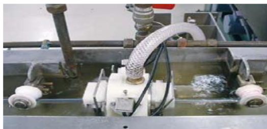
図 1-4 超音波肉厚測定装置 実験写真
