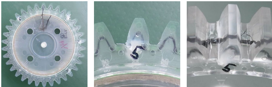
図 16 静的強度試験後の ABS 歯車（炭素繊維インサートあり）
