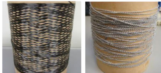
図 27 カバーリング炭素繊維 (左：カバーリング前、右：カバーリング後)
