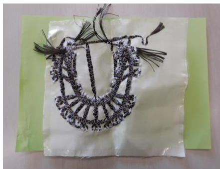
図 26 ベースの布に縫い付けられた炭素繊維のサンプル
