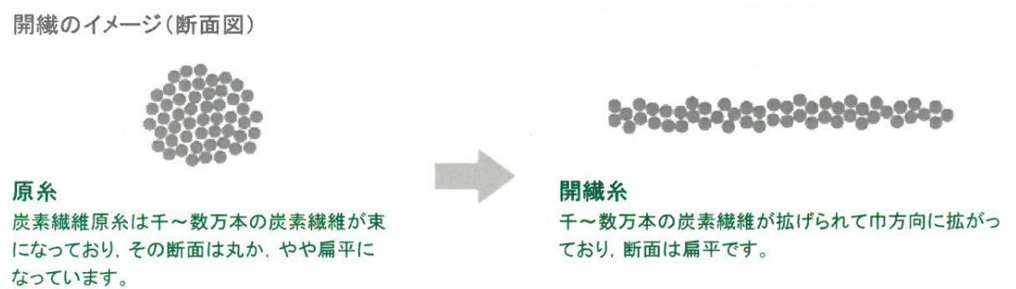
図 30 開織の説明（※サカイオーベックスホームページより）
