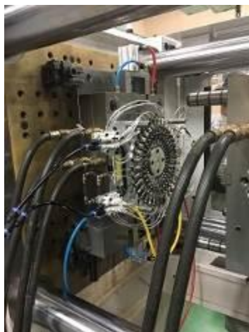
図 34 自動挿入装置を金型に設置した様子
