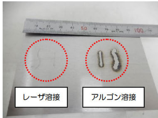
図23 レーザ溶接（左）とアルゴン溶接（右）のヒケ比較写真
