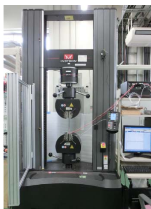
図 3.2.10 有孔引張試験片 (ASTM D5766 準拠) 図 3.2.11 有孔引張試験 (Instron 5958 型)
