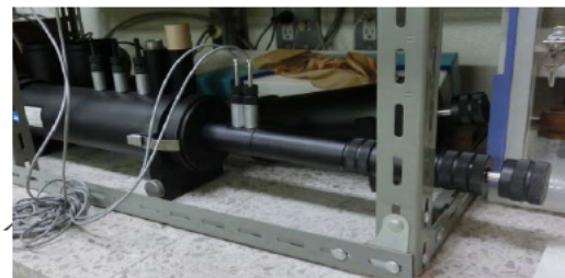
図 3. 4. 14 インピーダンスチューブ方式の 図 3. 4. 15 音響測定装置外観（下）と 音響測定装置模式図 試験片を吸音管に入れた状態（上）
