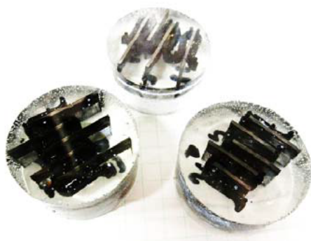
図 3.2.16 レーザ切断部のマイクロ試験片
