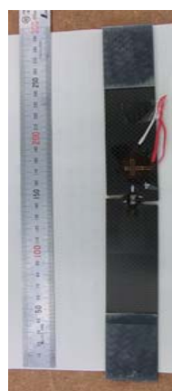
図 3.2.12 破断した引張試験片 (左) と破断部拡大 (右) (表側：右 裏側：左)
