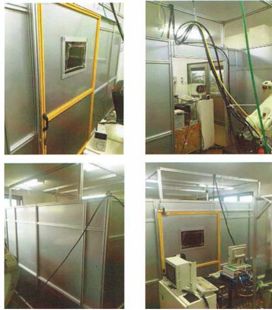
図 3.2.9 完成した安全柵
