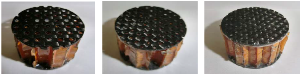
図 3. 4. 13 NC 加工後のインピーダンスチューブ試験用の試験片
