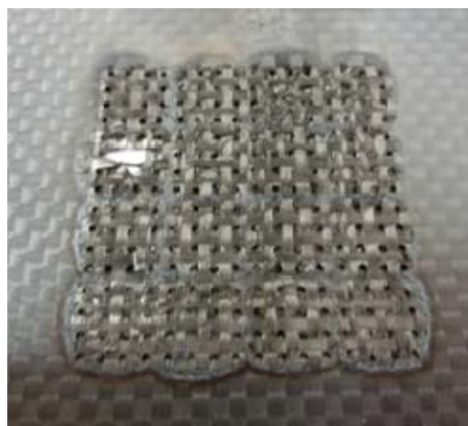
図 3.4.19 \phi 1.0\text{mm} の穴を256個あけたCFRP消音パネル上板
