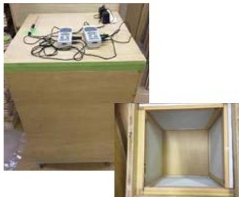
図 1 1 擬似気温調節ボックス (左) と擬似室内ボックス (右)
