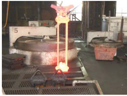
図 2-7 小型スリッターの熱処理時の様子
