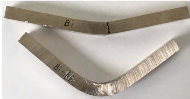
図 11 ビスマス（上）および微量元素添加ビスマス（下）の延性比較
