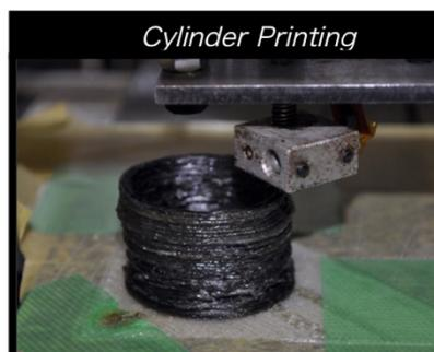
図 3 複合材 3D プリント成形物の例
