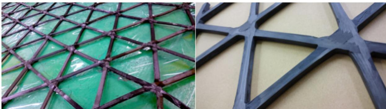
図 37 1m×1m のCFRP 製アイソグリッド構造体 (左) 積層直後 (右) 硬化後
