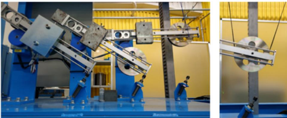
図 34 張力制御機構
