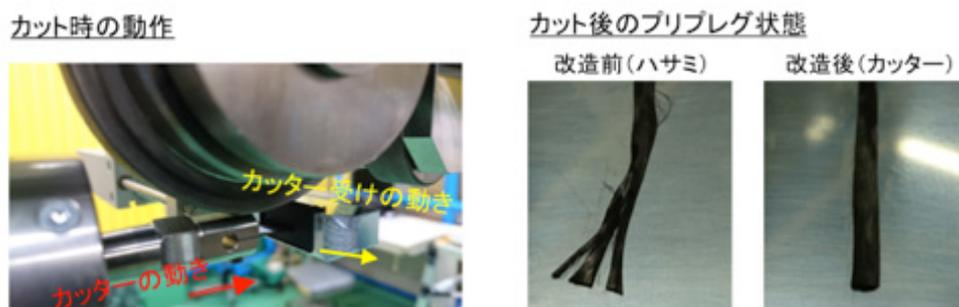
図 36 カット時の動作とカット後のプリプレグ状態
