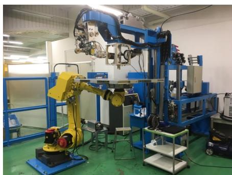
図 13 産業用ロボットに設置した成形装置全体図
