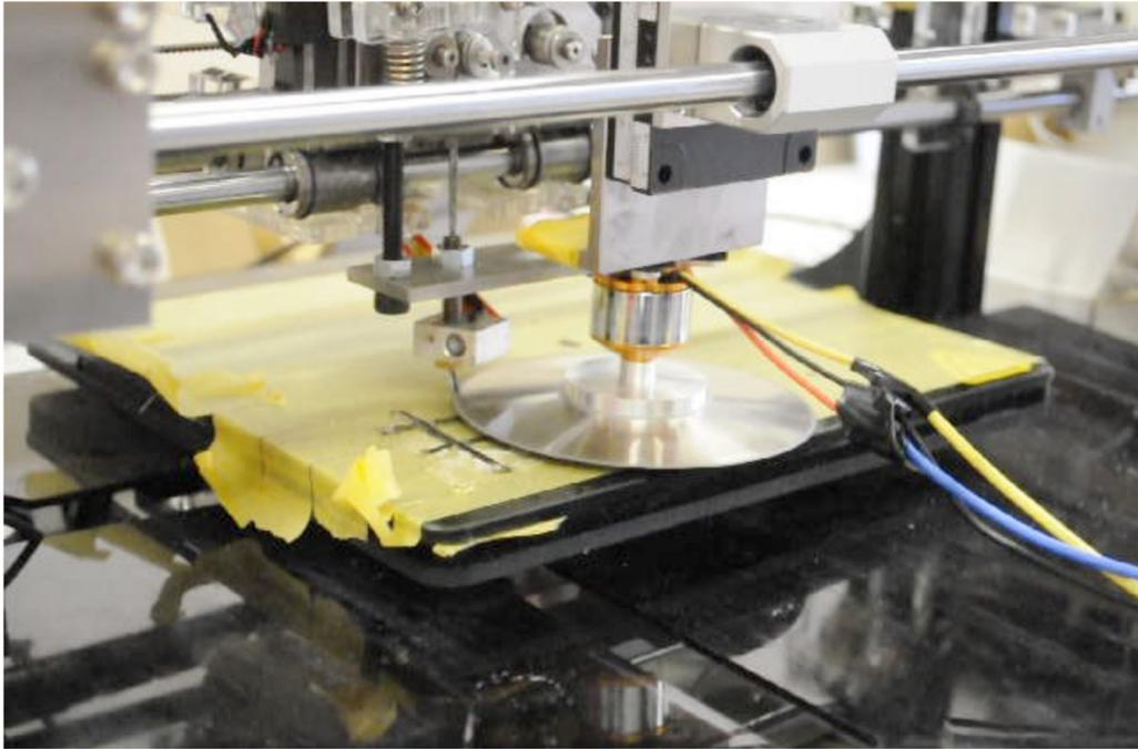
図4 ロータリーカッターによる繊維切断
