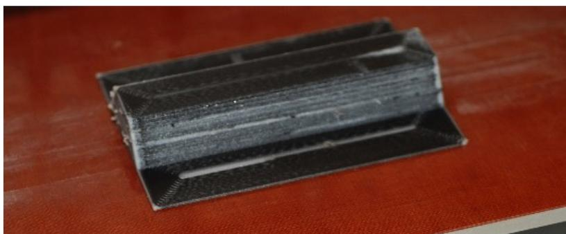
図 28 ハット型ストリンガ形状の製造性確認
