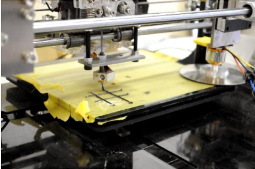
図 19 FDM 3D プリンターへの繊維切断機構の導入した装置写真
