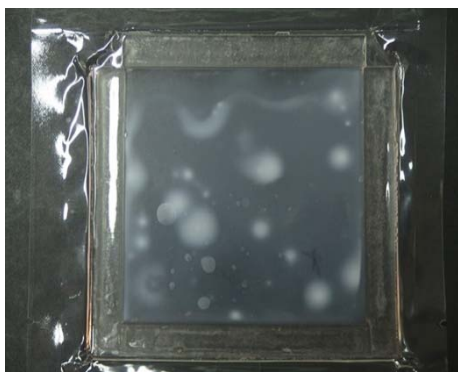
図2-3 紫外線により部分的に白濁した様子
