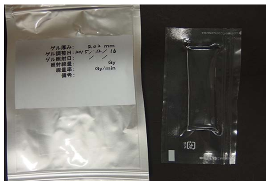
図2-4 アルミパックした状態での紫外線試験の結果 (白濁していない)
