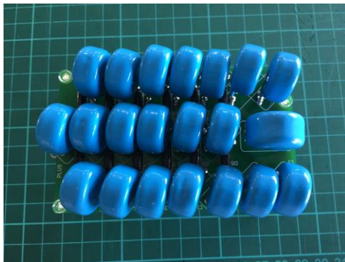
【コッククロフト・ウォルトン回路：陽極 7 段】
