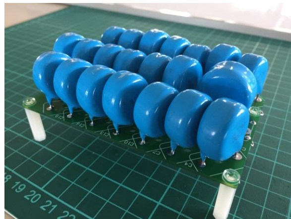
【コッククロフト・ウォルトン回路基板：陽極 7 段】
