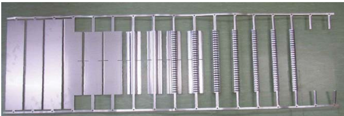
図 2.1 ヘッダーの成形加工工程
