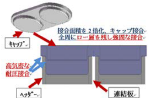
図 2.7 キャップとヘッダーの接合断面
