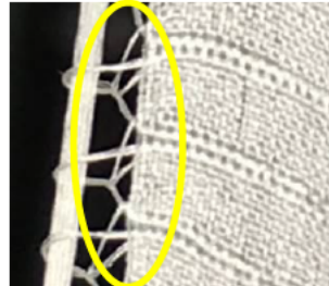
図A-5 12G用耳輪織物組織図、 写真A-1 完成した耳 写真A-2 耳輪系に地糸が 紋柵図、通し順 輪2mm 絡む（黄色枠）
